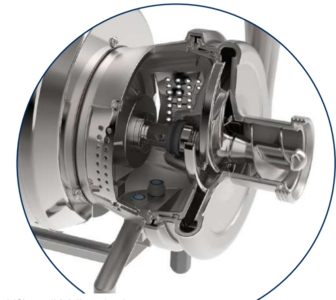
Version spéciale avec induceur à l'aspiration. Avec ce dispositif installé à l'aspiration de l'impulseur, il est possible de réduire la valeur du NPSH requis de la pompe.
