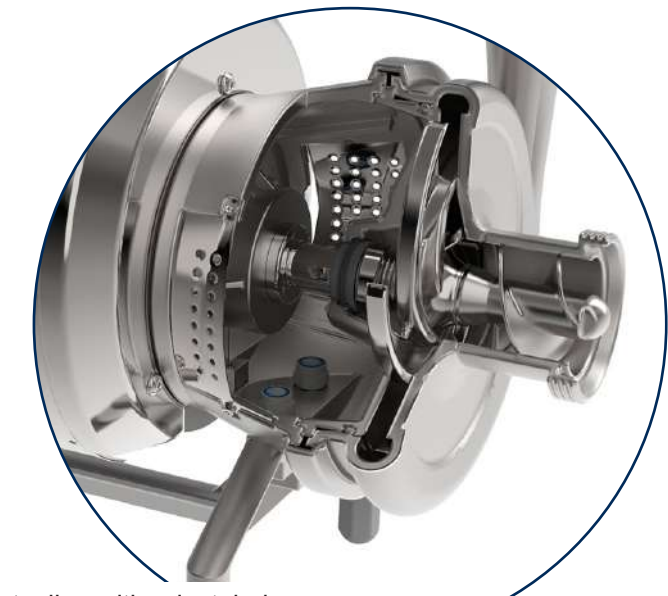
Versión especial con inducer en la boca de aspiración. Con este dispositivo, instalado en la aspiración de la turbina, es posible reducir el valor de NPSH requerido de la bomba.
