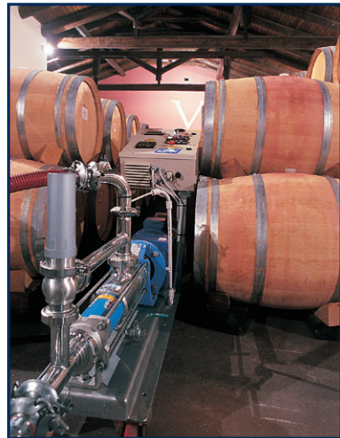
Baureihe MAE mit speziellen Funktionen zum Umfüllen von Barrique Fässern.
