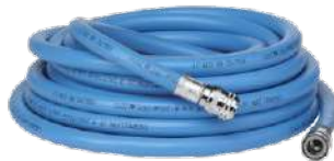
TUBO GOMMA VAPORE Press. di lavoro 10 Bar a 120°C Press. di esplosione 30 Bar a 120°C Range di T -30°/+120° 3/4" (Ø 19x31) - 1" (Ø 25x37) STEAM HOSE Working pressure 10 Bar at 120°C Explosion pressure 30 Bar at 120°C T range -30°/+120° 3/4" (Ø 19x31) - 1" (Ø 25x37)
