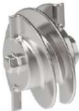
Schneckenrotor aus Edelstahl Feinguss sichert den Flüssigkeitsring im Rotorgehäuse.
